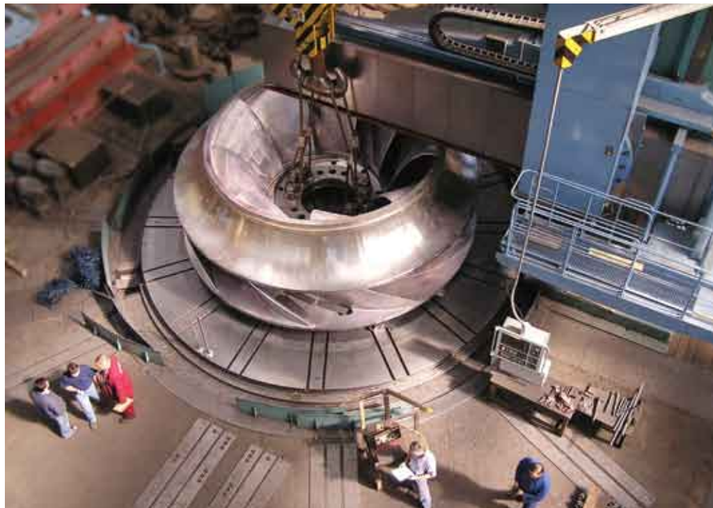
Рис. 2: «ČKD Blansko Holding». Радиально-осевая обратимая гидротурбина Френсис. Pic 2: «ČKD Blansko Holding». Radial-axial reversible hydraulic turbine Francis
