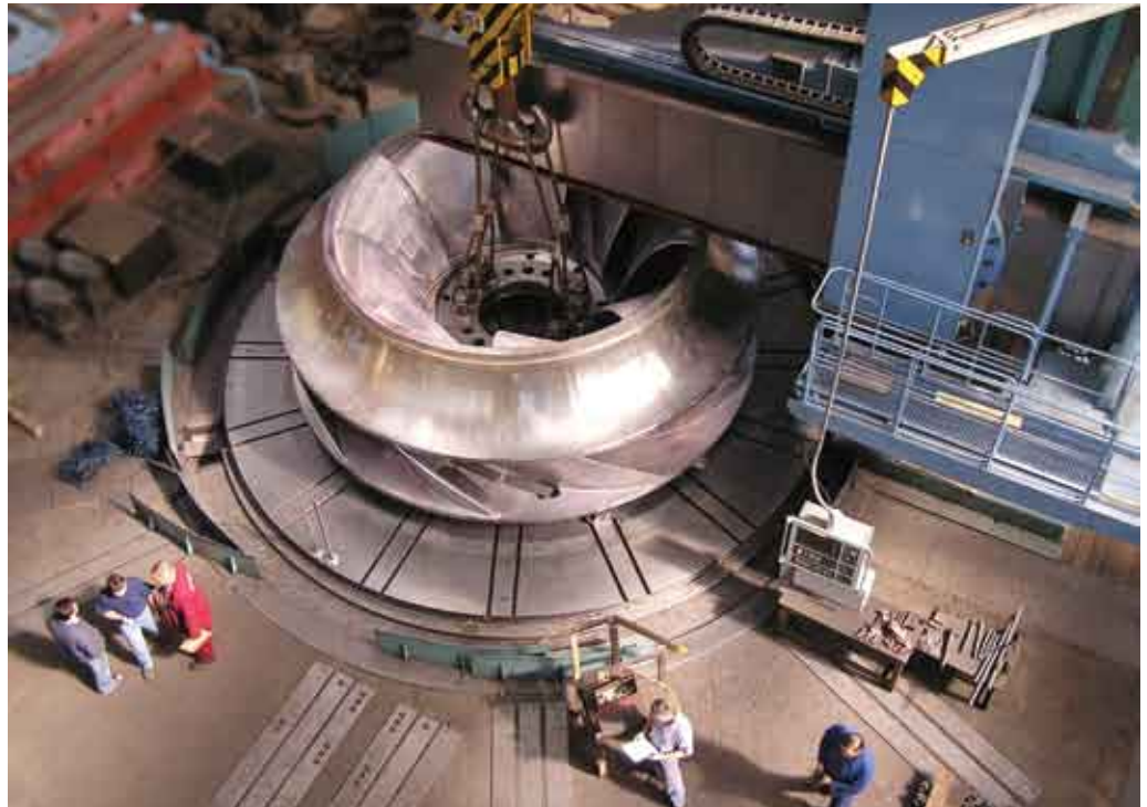
Рис. 2: «ČKD Blansko Holding». Радиально-осевая обратимая гидротурбина Френсис. Pic 2: “ČKD Blansko Holding”. Radial-axial reversible hydraulic turbine Fransis
